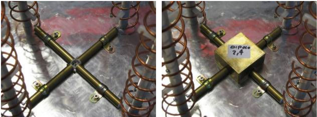
Particolare dell'accoppiatore a 4 vie a linea coassiale
