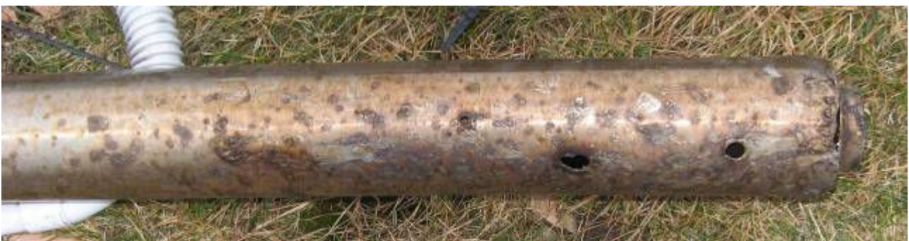
Antenna dipolo \frac{1}{2} onda frequenza 70 MHz in acciaio con evidenti segni dovuti a scariche elettriche
